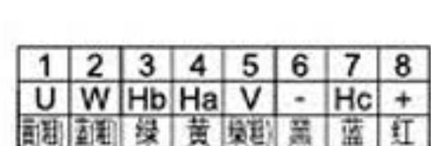
高压电机接线插孔对应信号说明
